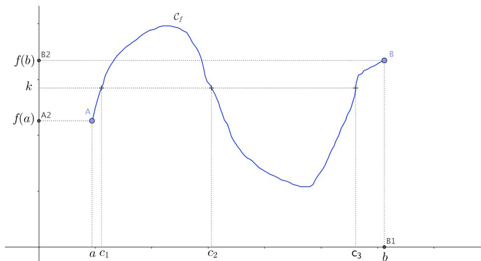
Dans la figure ci-dessus, la fonction  $f$  est continue sur l'intervalle  $[a ; b]$ . Donc pour tout réel  $k$  compris entre  $f(a)$  et  $f(b)$ , l'équation  $f(x) = k$  possède au moins une solution. Ici, elle possède trois solutions  $c_1, c_2$  et  $c_3$ .
